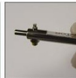
El conector angulado se ajusta con la herramienta
